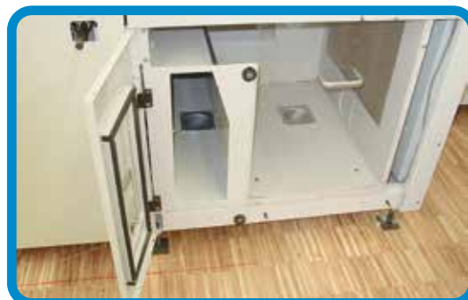
Camere di filtro della macchina di filatura ad aria
