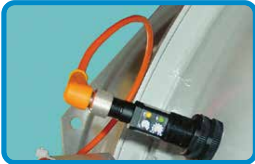
Sicurezza di troppo pieno: segnale per differenti indicazioni od ordini di controllo
