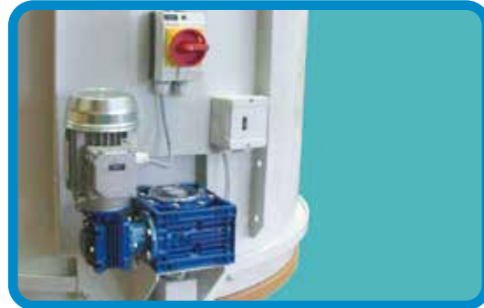
Apertura a motore del coperchio, per lo svuotamento controllato
