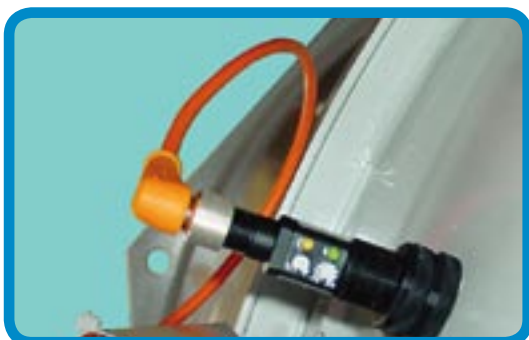
Dispositivo indicador de filtro cheio: sinal para diferentes indicações ou ordens de controle
