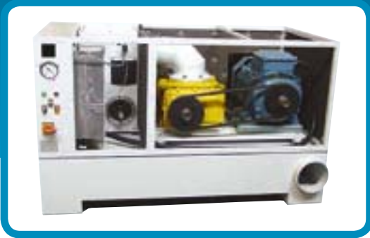
Unidad de vacío con vista al interior
