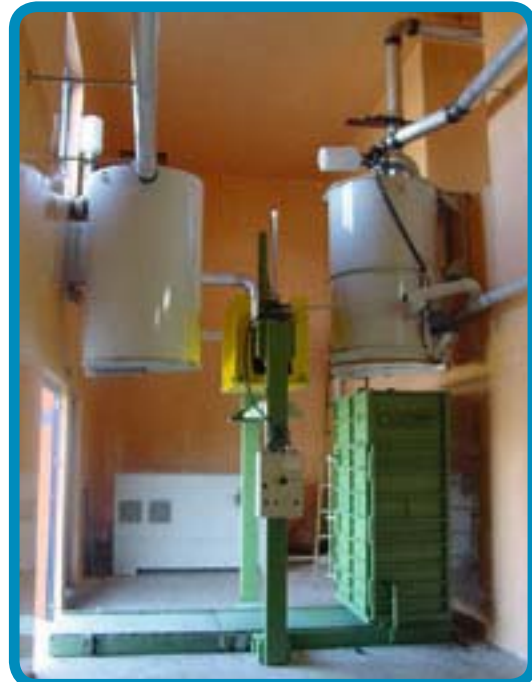
Filtro sobre la prensa de balas
