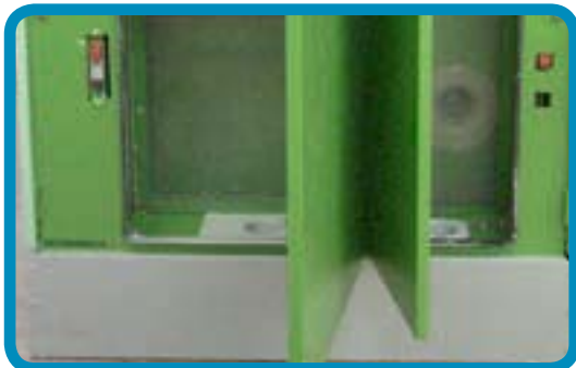
Cámaras de filtro de la maquina de hilatura a rotor
