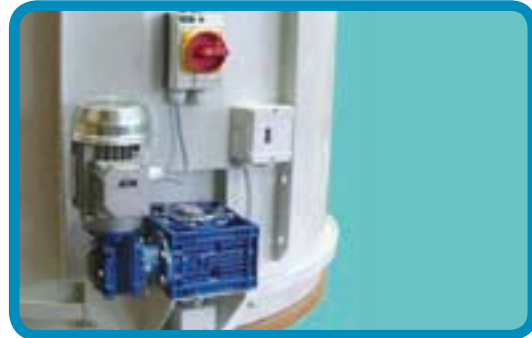
Apertura a motor de la tapa, para un vaciado controlado
